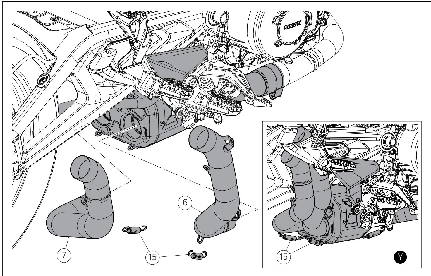
Inserire il collettore anteriore silenziatore (6) e il collettore posteriore silenziatore (7) nel gruppo risonatore (5) appena installato.
